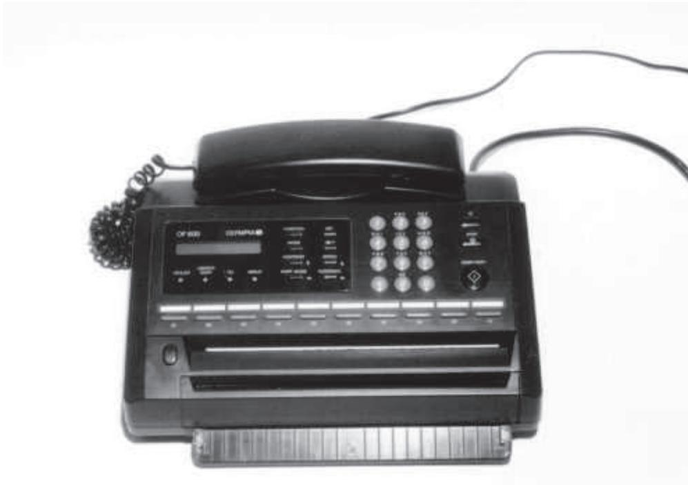
Abbildung 5.38: Kombi gerät, hier Telefon mit integriertem Fax
